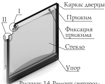
Рисунок 14. Ремонт светопрозрачного экрана дверцы модели «Витра»
