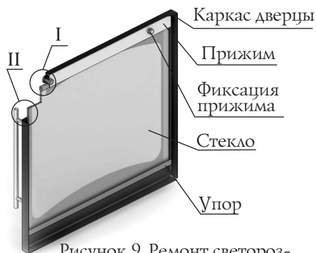
Рисунок 9. Ремонт светопрозрачного экрана двери модели «Витра»
