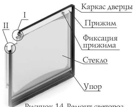
Рисунок 14. Ремонт светорозрачного экрана дверцы печи «Витрувия»
