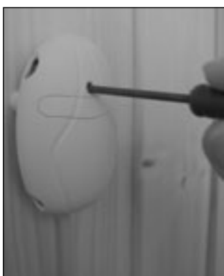
Рисунок 16. Кнопка возвращения предохранителя от перегрева
