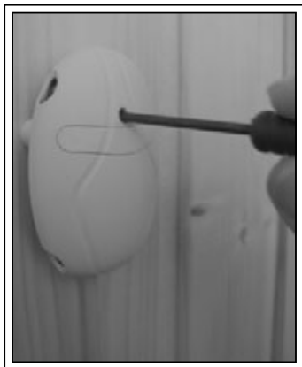
Obr. 9. Tlačítko nastavení výchozího stavu omezovače přehřátí Obrázok 9. Tlačidlo pre spätný chod ochrany proti prehriatiu
